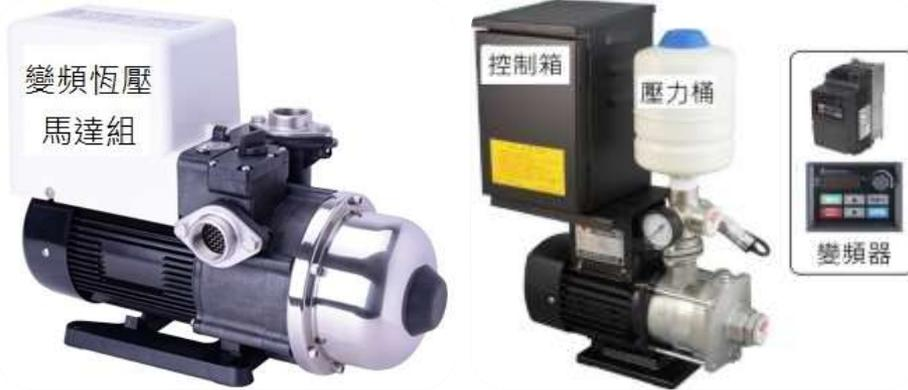
馬達平緩啟動，變頻器以壓力感應器回傳值為依據，進而控制馬達運轉之頻率。無段改變馬達轉速，使得水壓力穩定維持在壓力設定值，適合使用於各種灌溉場所。
