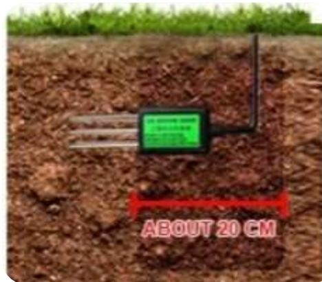
土壤水分/電導率/溫度感測器
